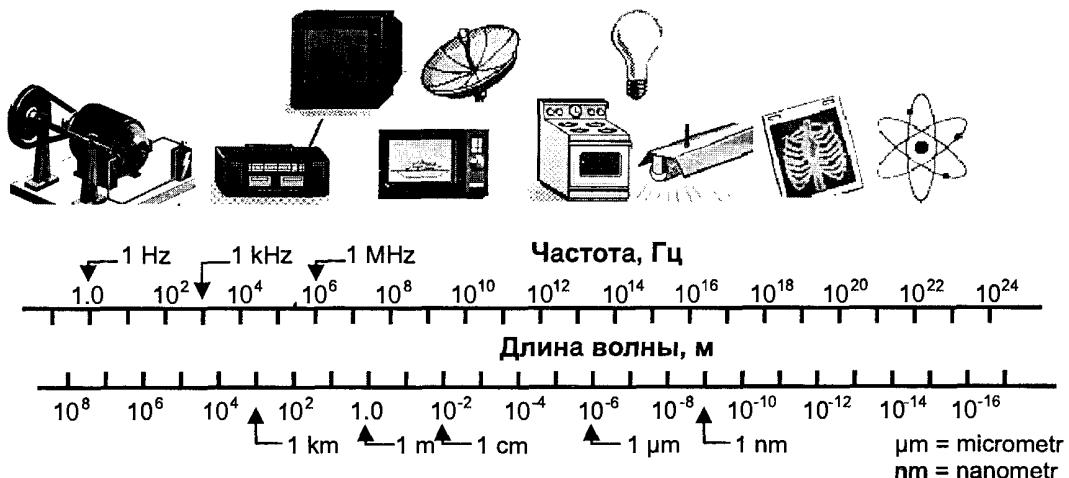
Рис. 1.1. Шкала электромагнитных волн
